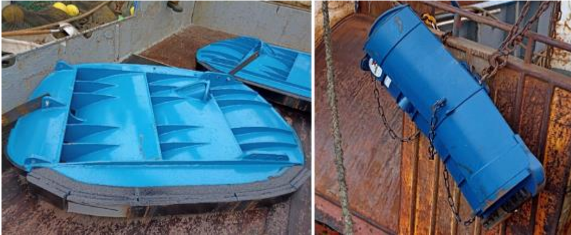
Figura 1. A la izquierda se observa una de las puertas Oval Foil utilizadas por el buque “Plaia de Rueta” con las quillas de refuerzo soldadas al comienzo de la campaña experimental REDIPESCA2. A la derecha se observa la puerta pelágica testada en este estudio.
