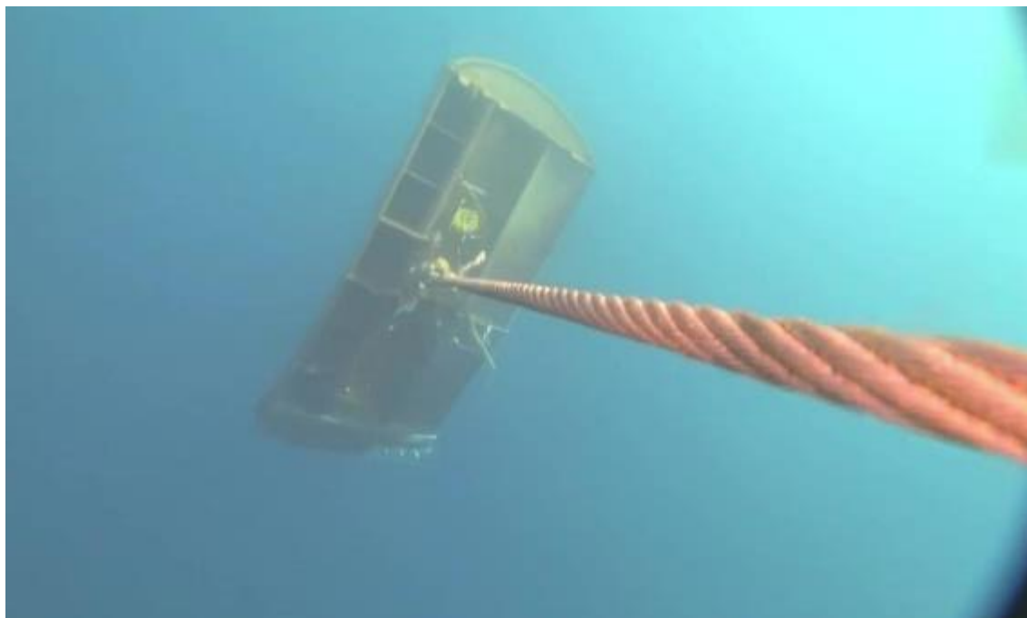
Figura 6. Puerta Pelágica modelo Type 23 de ThyborØn trabajando durante la pesca de arrastre de fondo.
