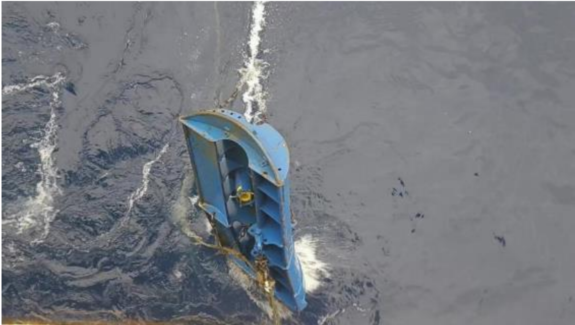
Figura 6. Puerta pelágica modelo Type 23 de ThyborØn entrando en el agua durante la operación de largada.
